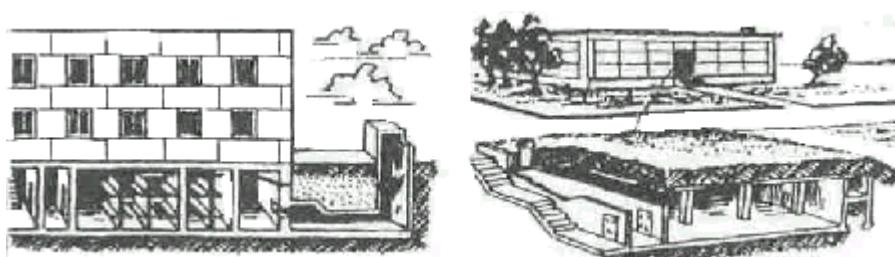
Для оборудования укрытия используются подвалы зданий построенных из кирпича, из сборных железобетонных конструкций или монолитного железобетона (монолитный железобетонный каркас и кирпичные стены) способные выдержать обрушение выше расположенных этажей, способные обеспечивать защиту от воздействия избыточного давления по фронту воздушной ударной волны равного  $0,5 \text{ кгс/см}^2$ , имеющие 2-а и более выходов.
