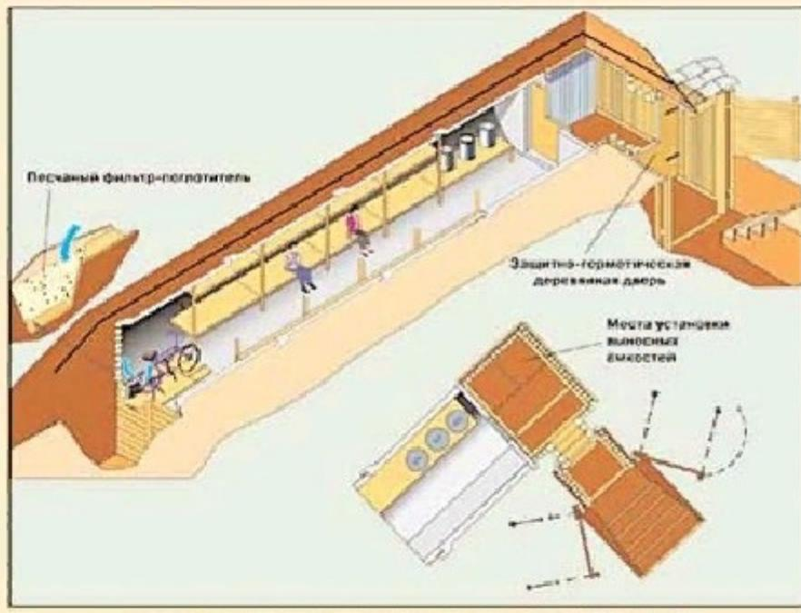
Быстроустанавливаемое убежище из железобетонных труб большого диаметра
