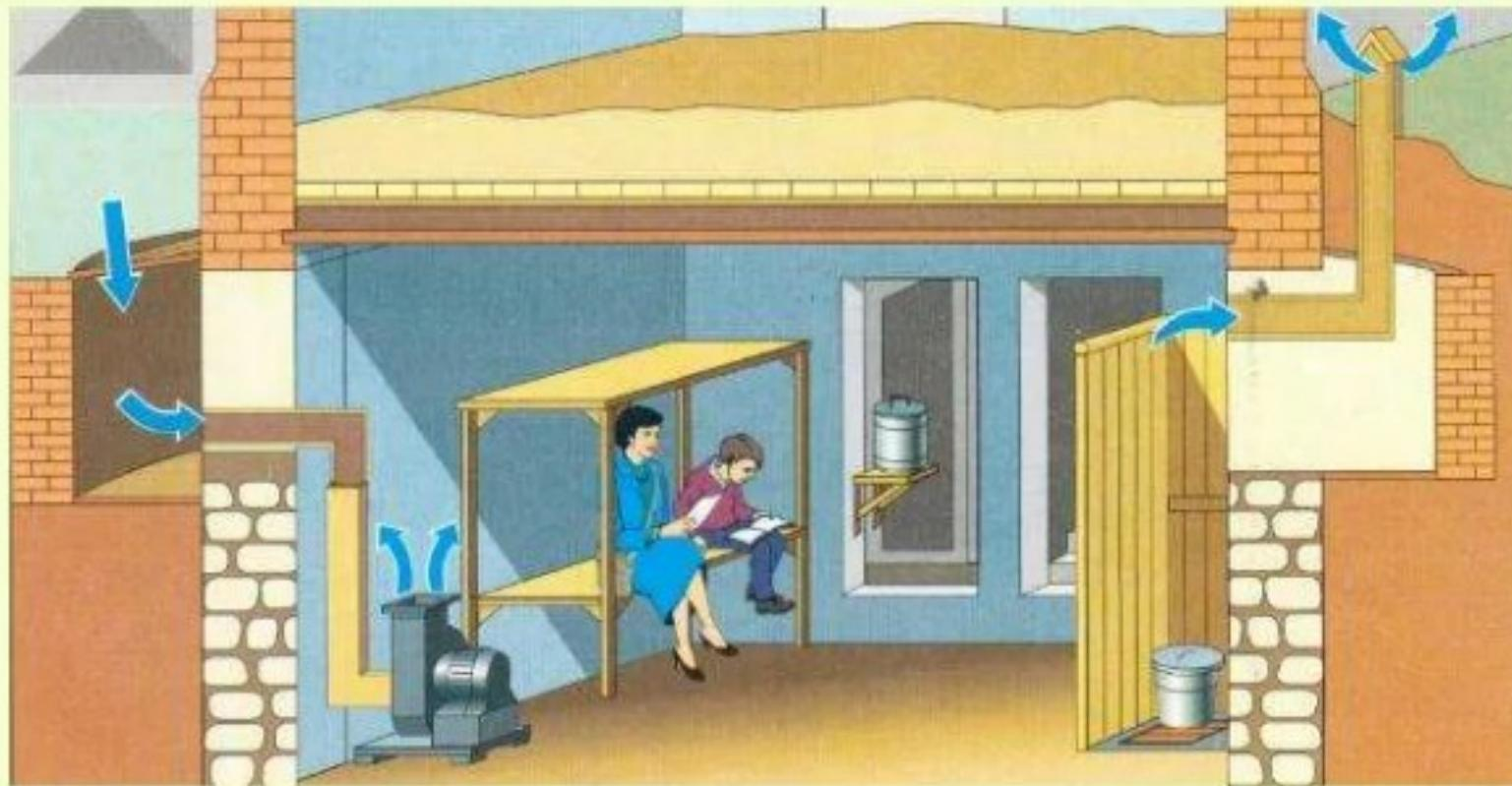
Под них обычно используют подвальные или полуподвальные этажи производственных, общественных и жилых зданий. Конструктивную схему встроенных убежищ выбирают с учетом конструкции здания (сооружения), в которое встраивается убежище, и на основе технико-экономической оценки объемно-планировочных решений по использованию помещения в мирное время.
